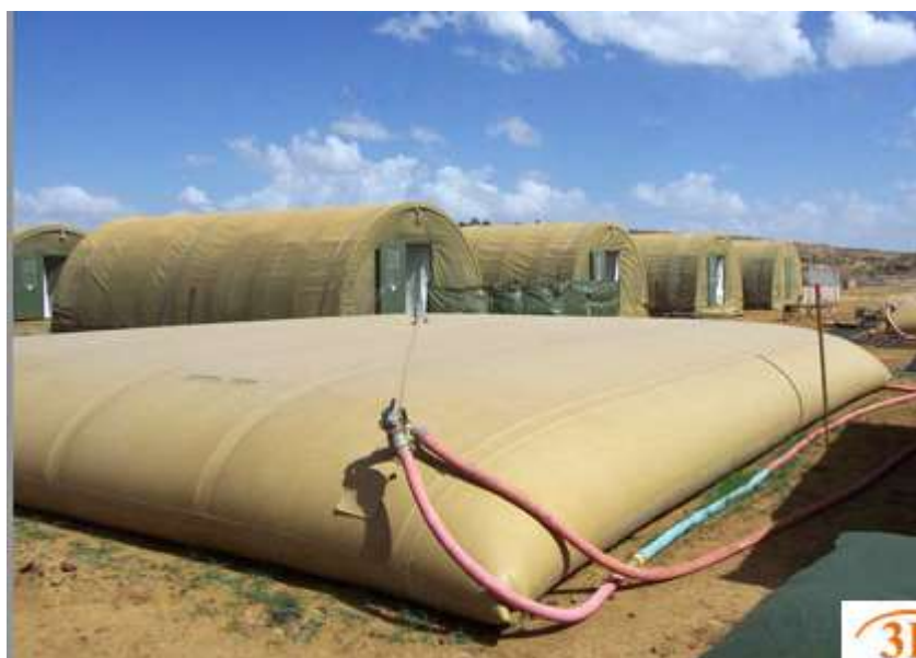
FIGURA 2.14. TANQUE DE ALMACENAMIENTO
