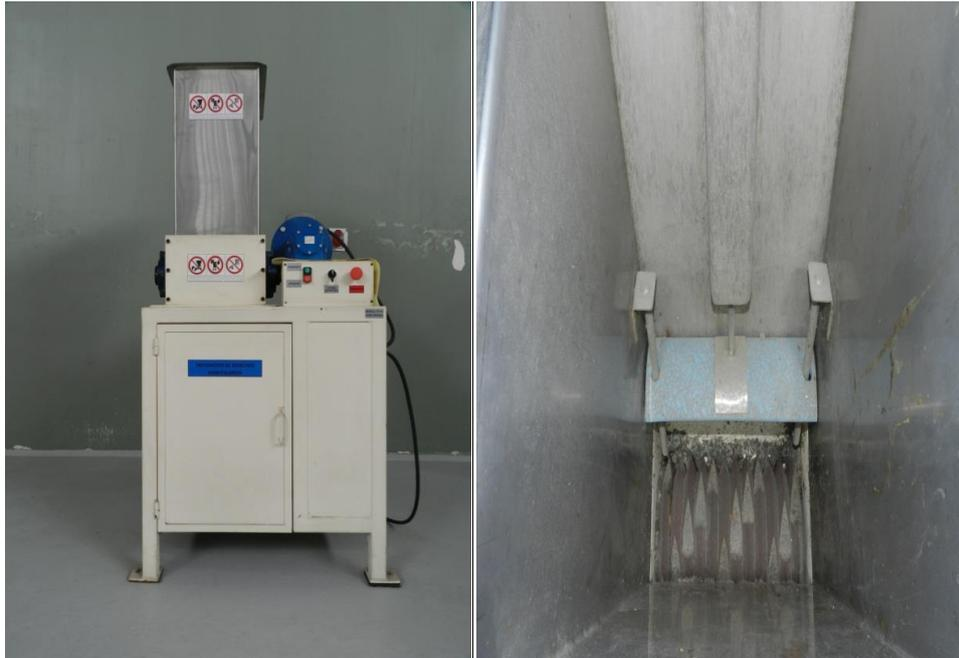
**FIGURA 3.10 TRITURADORA EN VISTA FRONTAL Y SUPERIOR**
