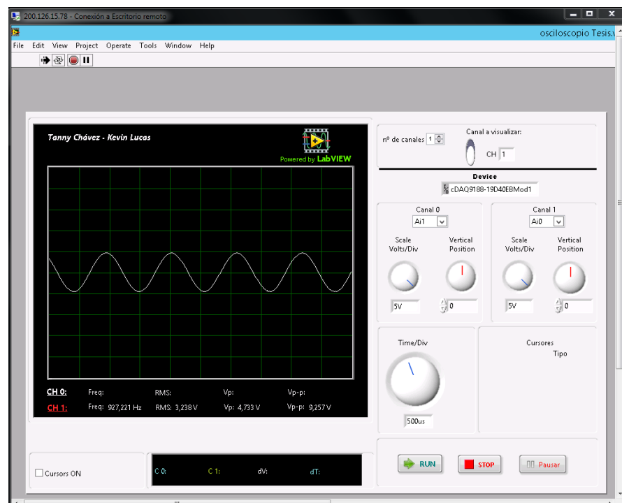
Figura 4.25 Señal sinusoidal adquirida por el Osciloscopio Virtual utilizando la Sesión 1 de escritorio remoto.
