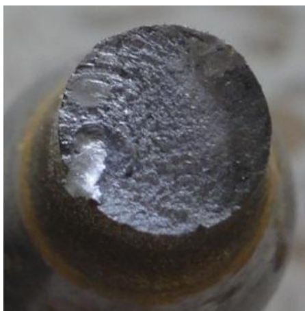
FIGURA 3.22: CONDICIÓN DE LA SUPERFICIE FRACTURADA EN UNA PROBETA ENSAYADA
