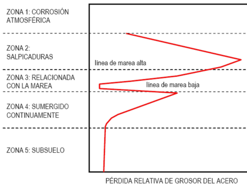
FIGURA 2.4: EFECTO DE LA PROFUNDIDAD DEL AGUA DE MAR EN LA CORROSIÓN DEL ACERO
