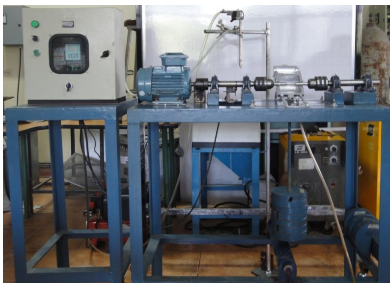
FIGURA 2.14: VISTA GENERAL DE LA MÁQUINA DE ENSAYOS CON SISTEMA DE CORROSIÓN INCORPORADO
