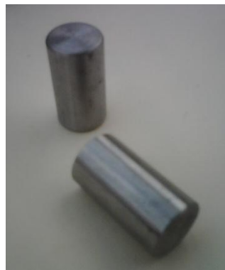
FIG. 3.2 FOTOGRAFÍA DE LA PROBETA PARA ENSAYO DE DUREZA
