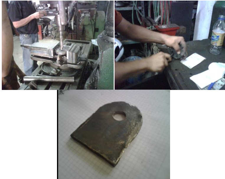
FIG. 2.16 PROCESO DE CONSTRUCCIÓN DE LAS PLACAS DE SOPORTE
