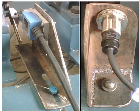
FIG. 2.21 FOTOGRAFÍA DE LOS SOPORTES TERMINADOS
