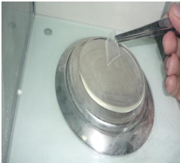
FIGURA 3.52 PESAR LA MUESTRA EN LA BALANZA
