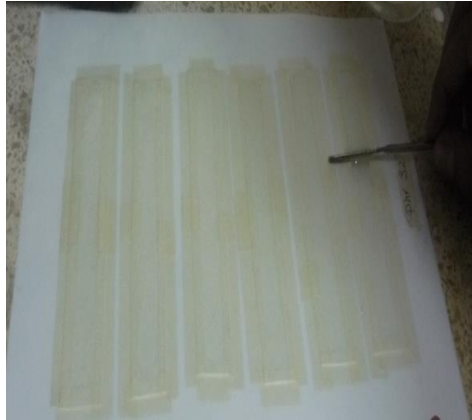
FIGURA 3.45 NIVELAR EL CONTENIDO DE LA MEZCLA EN LOS MOLDES
