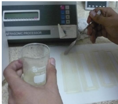
FIGURA 3.44 RELLENAR LOS MOLDES CON LA MEZCLA
