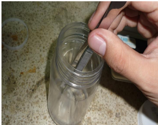
FIGURA 3.49 COLOCAR LA MUESTRA EN UN RECIPIENTE CON EL LÍQUIDO CORRESPONDIENTE (ALCOHOL O XILENO)
