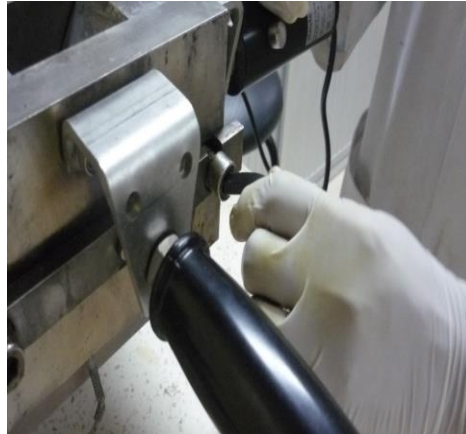
FIGURA 3.24 RETIRAR LA PARTE FRONTAL DEL EQUIPO
