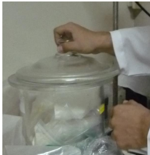
FIGURA 3.32 MEZCLA ARCILLA-INHIBIDOR ALMACENADA EN EL DESECADOR
