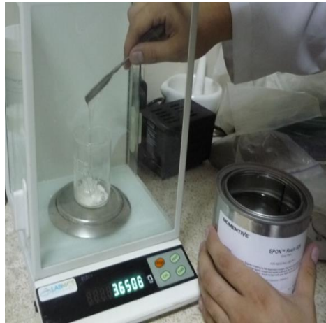
FIGURA 3.35 AGREGAR EL EPÓXICO
