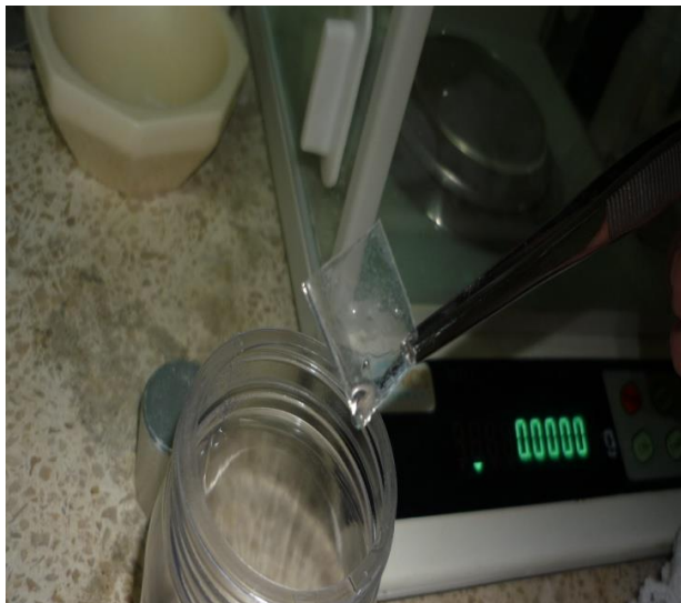
FIGURA 3.50 USO DE LA PINZA PARA RETIRAR LA MUESTRA
