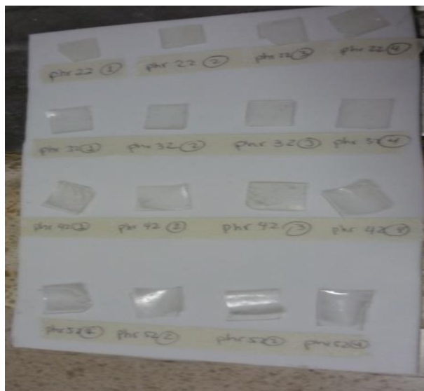
FIGURA 3.53 MUESTRAS HINCHADAS COLOCADAS SOBRE EL TEFLÓN PARA SECAR EN EL HORNO
