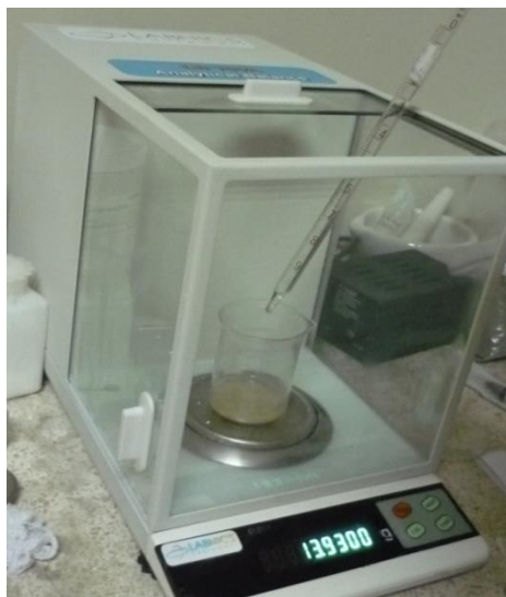
FIGURA 3.42 AGREGAR LA AMINA UTILIZANDO LA PIPETA
