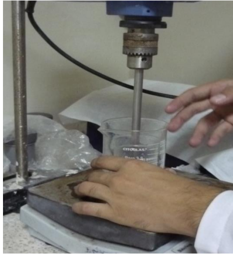
FIGURA 3.39 AJUSTAR LA POSICIÓN DEL AGITADOR PARA QUE HAGA CONTACTO CON LA MEZCLA
