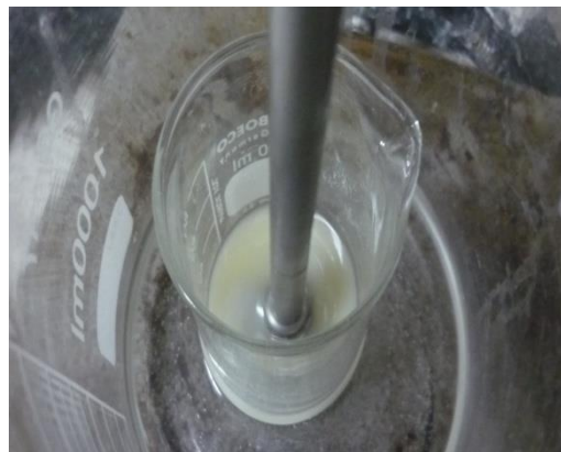
FIGURA 3.40 ASEGURARSE QUE LA HÉLICE NO TOQUE EL FONDO DEL VASO
