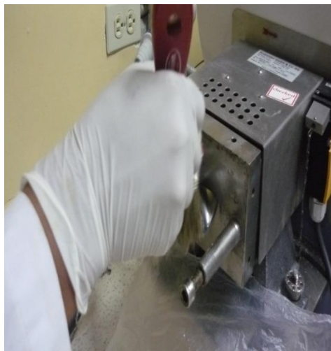
FIGURA 3.27 USO DE LA BROCHA PARA RETIRAR LA MEZCLA
