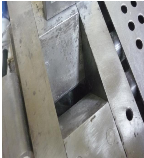
FIGURA 3.26 RANURA PARA COLOCAR LA MEZCLA
