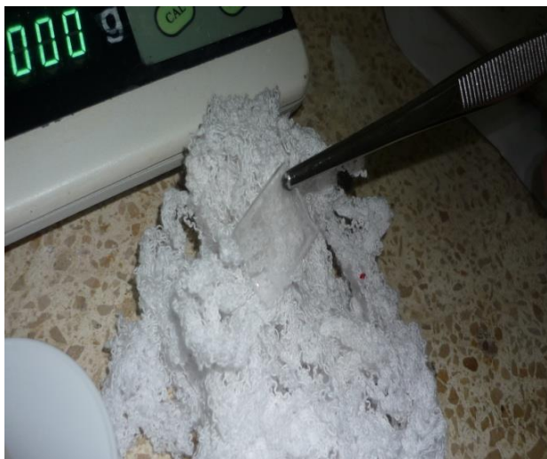
FIGURA 3.51 COLOCAR SOBRE EL WAIPÉ Y SECAR LA MUESTRA
