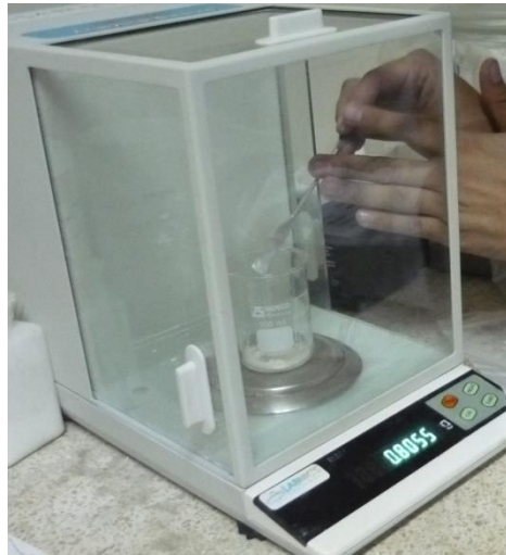
FIGURA 3.34 COLOCAR CUIDADOSAMENTE LA CANTIDAD PRECISA DE LA MEZCLA ARCILLA-INHIBIDOR
