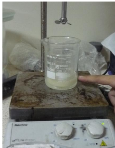
FIGURA 3.38 COLOCAR VASO CON LA MEZCLA EPÓXICO- ARCILLA-INHIBIDOR DENTRO DEL OTRO VASO
