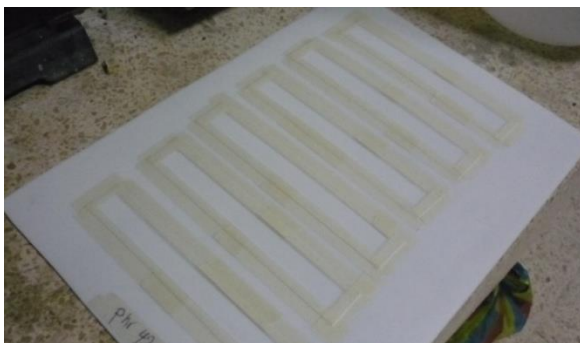
FIGURA 3.30 MOLDES PEGADOS CON CINTA ADHESIVA AL TEFLÓN
