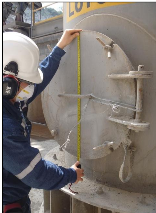
FIGURA 2.2. TOMA DE DIMENSIÓN DEL MANHOLE
