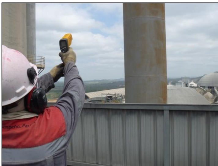
FIGURA 2.6. MEDICIÓN DE TEMPERATURA EN LA CHIMENEA
