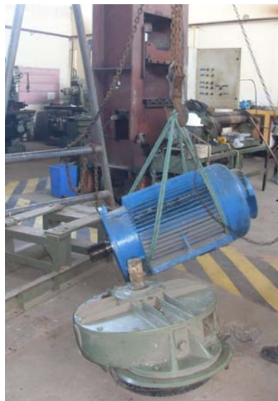
FIGURA 2.36. DESMONTAJE DE LAS PARTES DEL MOTO-REDUCTOR
