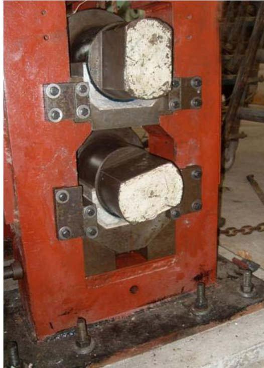
FIGURA 2.8. MONTAJE DE LOS RODILLOS
