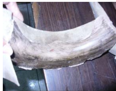
FIGURA 2.1.A) REPRODUCCIÓN DE CURVATURA DE RODILLO, NEGATIVO DE LA CURVATURA;
