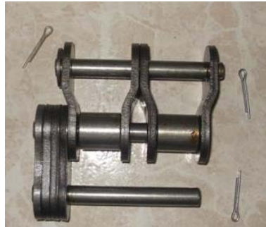
FIGURA 2.24. MUESTRA DE LA CADENA Nº 120, SEGÚN MARTIN.
