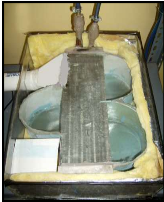
Figura 1.11 – Intercambiador de Calor
