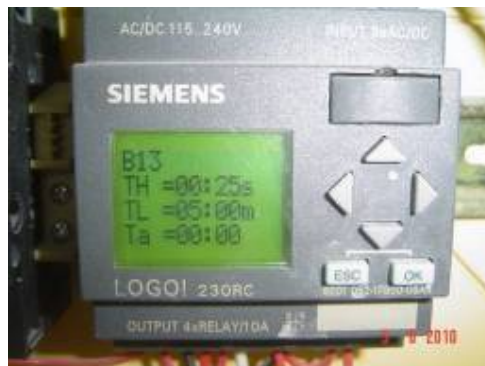
Entrada del Parámetro B13 al PLC
