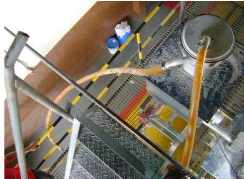
producir caídas al operador de la máquina. Esto incumple con el Artículo 76 del Decreto Ejecutivo 2393, el cual establece que todas las partes fijas o móviles de motores, órganos de transmisión y máquinas, agresivos por acción atrapante, cortante, lacerante, punzante, prensante, en que resulte técnica y funcionalmente posible, serán eficazmente protegidos mediante resguardos u otros dispositivos de seguridad.
