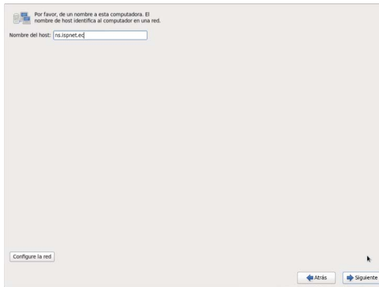
Figura 2.27 Instalación mínima de Centos 6 Se ingresa el nombre host del servidor en este caso ns.ispnet.ec
