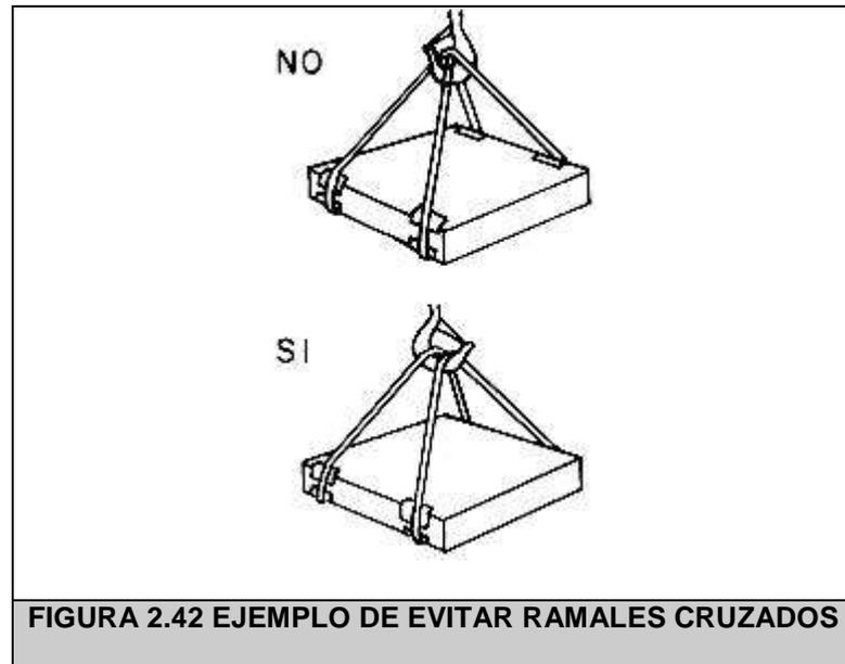
Antes de la elevación completa de la carga, se deberá tensar suavemente la eslinga y elevar aquélla no más de 10 cm. para verificar su amarre y equilibrio. Mientras se tensan las eslingas no se deberán tocar la carga ni las propias eslingas.
