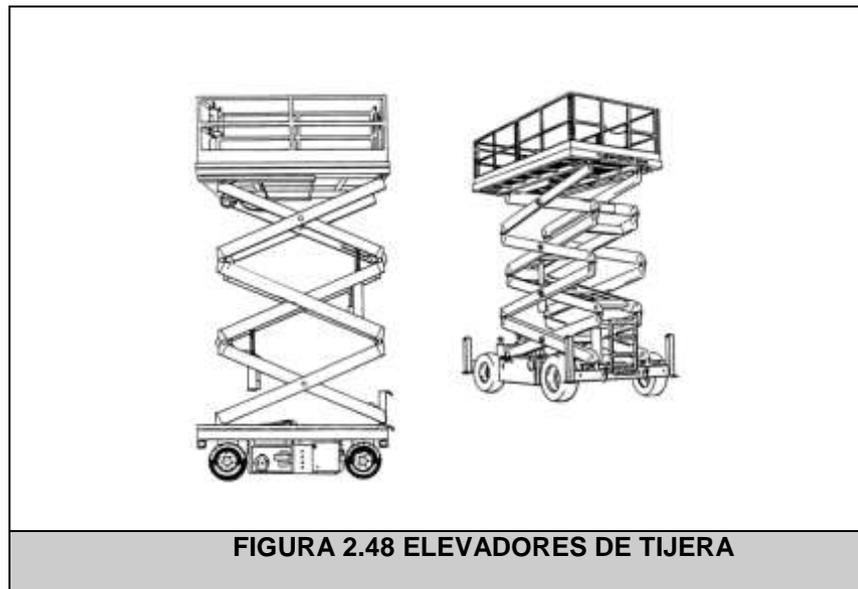
Equipo de ascenso vertical usado para labores en línea perpendicular a la base de apoyo.
