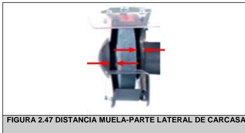
Se debe instalar un interruptor o dispositivo de parada de emergencia al alcance inmediato del operario. El apoya herramientas debe ser regulable y La distancia entre este y la muela debe ser de 2 milímetros, en ningún caso puede superar los 3 milímetros.
