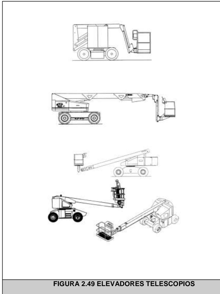
Equipo de ascenso versátil que permite desplazamiento horizontal y vertical de la pluma, logrando acceder lugares con obstáculos.
