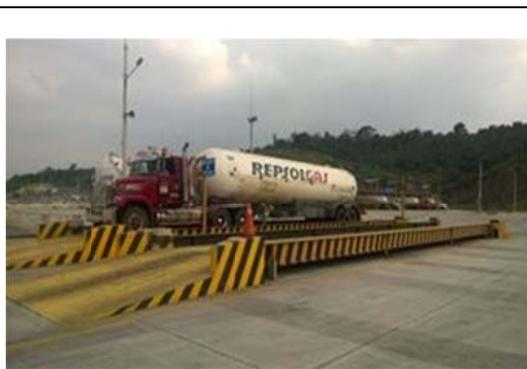
**Figura 15. Balanzas para Tanqueros**
