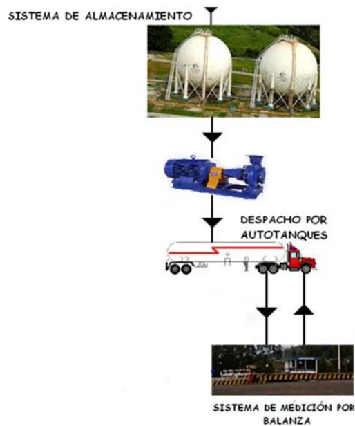
**Figura 1. Diagrama de Proceso de Despacho de GLP**
