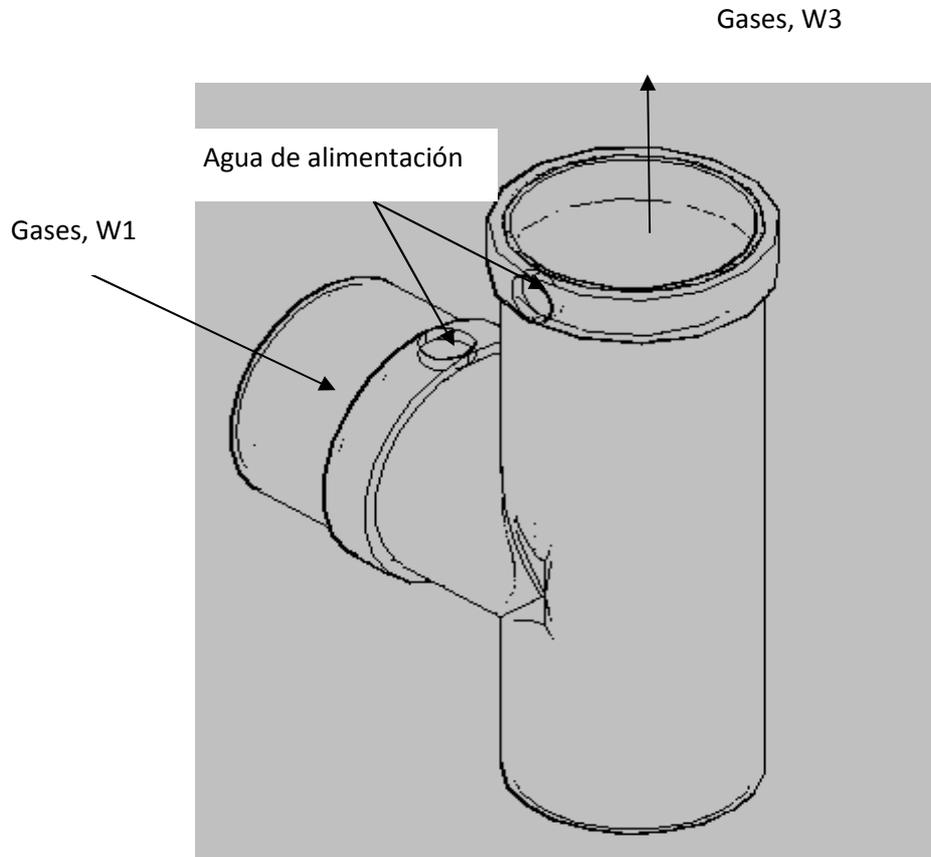
**FIGURA 30.****HUMIDIFICADOR HORIZONTAL Y VERTICAL**
