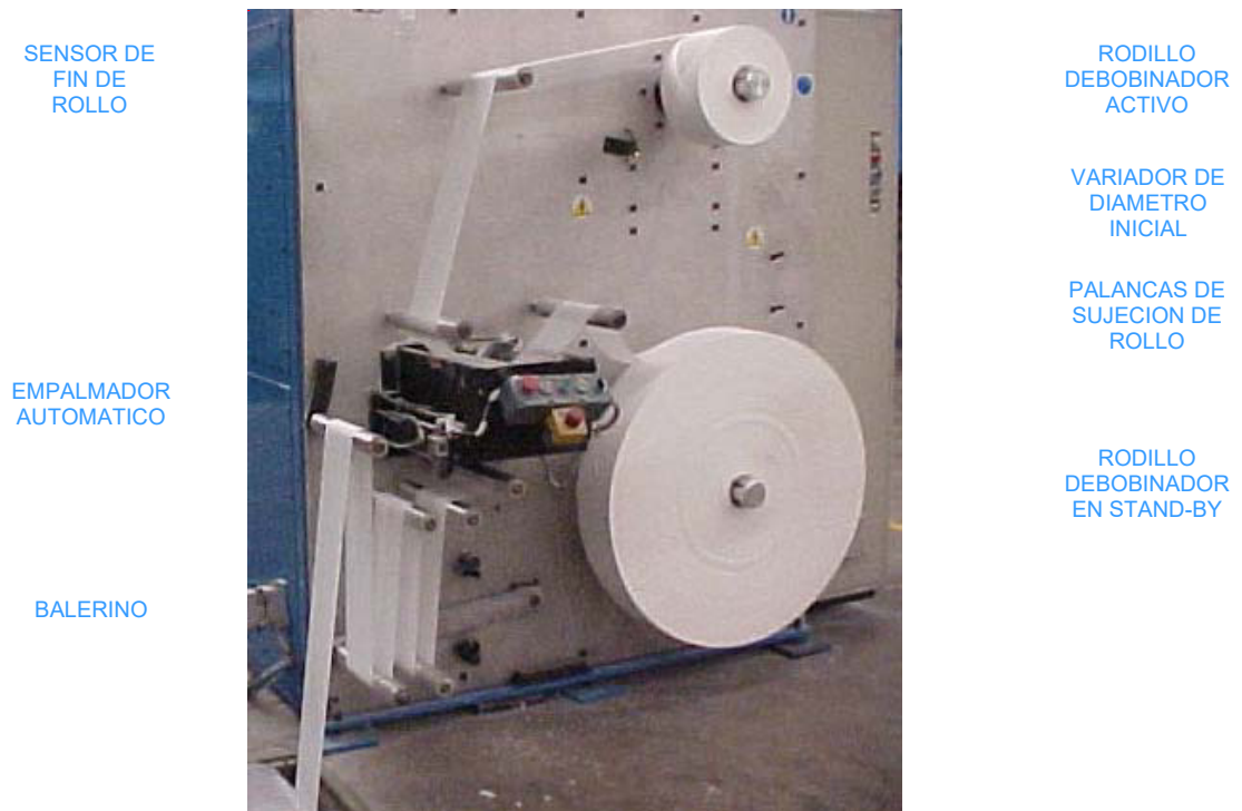
FIGURA 3.7 DEBOBINADOR TISSUE INFERIOR
