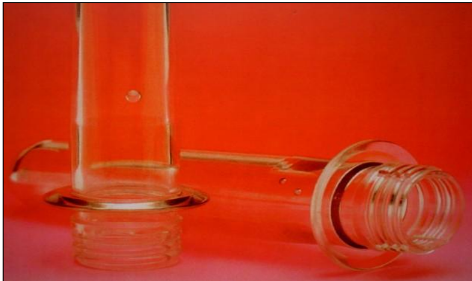
Figura 7. Presencia de pellets con burbujas en cuerpo de la preforma.
