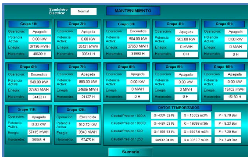
Figura 28.- Mímica Mantenimiento Bombas Horizontales
