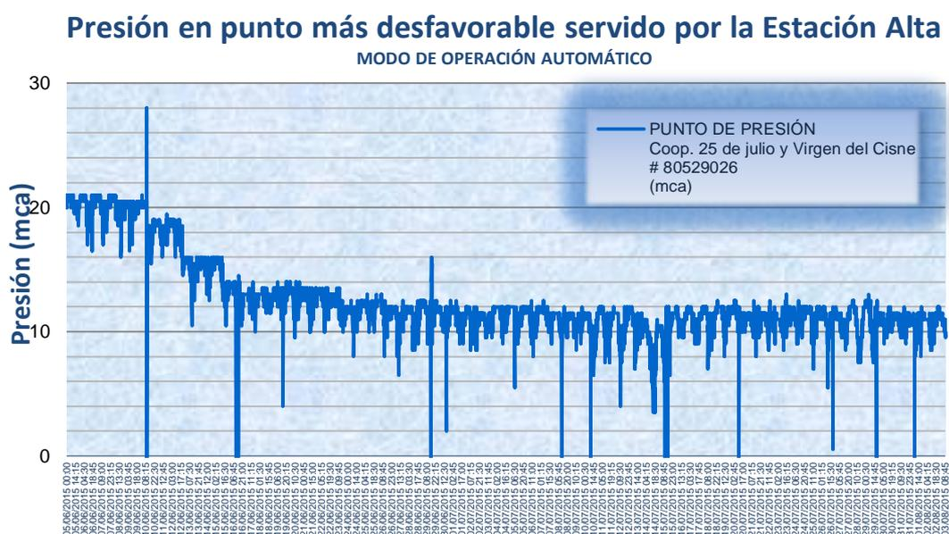
**Figura 24.** Presión en el punto crítico de la zona servida por la Estación Alta en modo Automático de operación.
