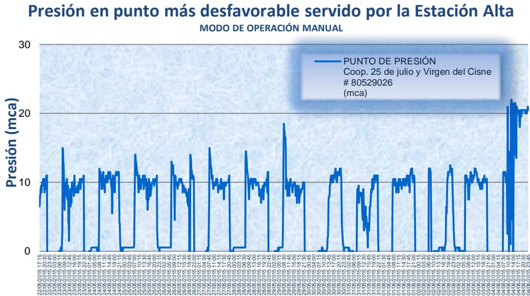
**Figura 22.** Presión en el punto crítico de la zona servida por la Estación Alta en modo Manual de operación.
