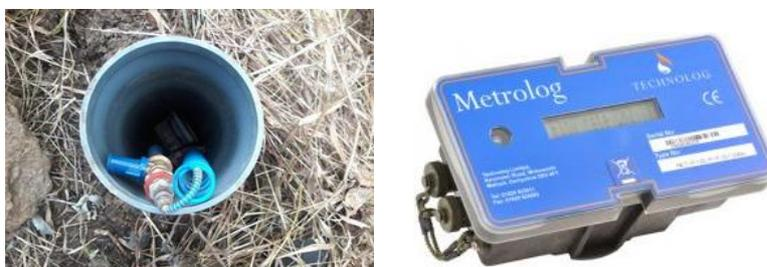
**Figura 21.** Implementación del punto de monitoreo de presión en NRO-932.
