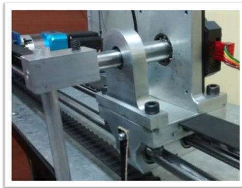
FIGURA 1.5. DETALLE DEL MÓVIL, BANDA, GUÍAS DE DESLIZAMIENTO Y PÉNDULO.
