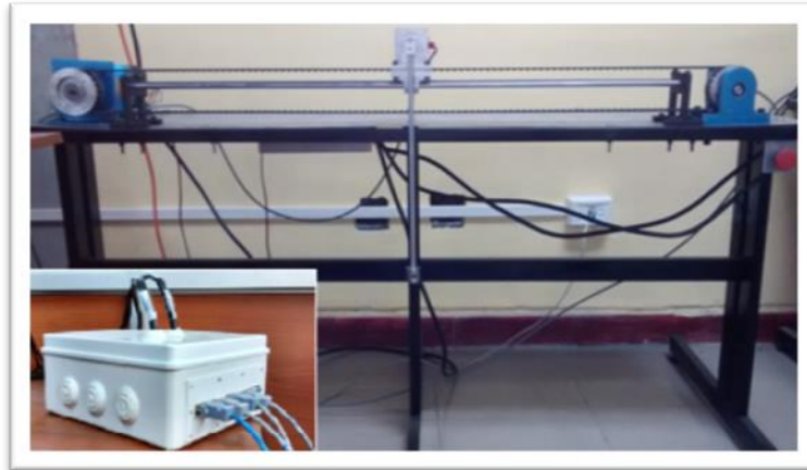
FIGURA 1.14. SISTEMA DE PÉNDULO INVERTIDO REAL CON DETALLE DE CAJA DE CONEXIONES
