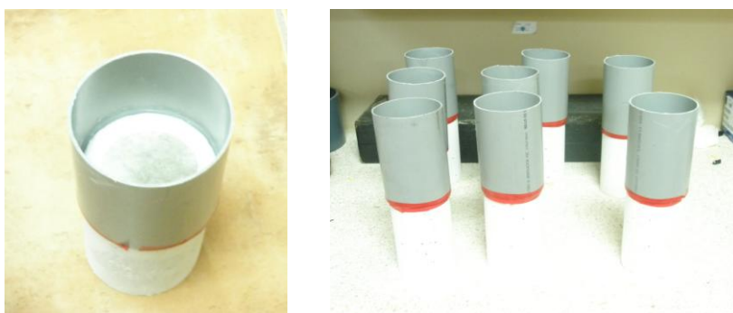
Fig. 2.8 Esquema básico del sistema empleado para difusión de cloruros
