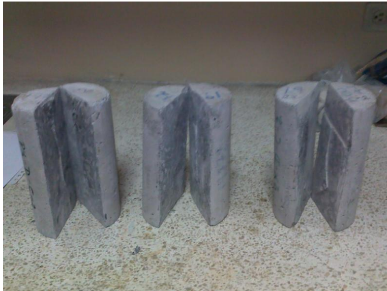
Fig. 2.24 Corte longitudinal de las probetas carbonatadas
