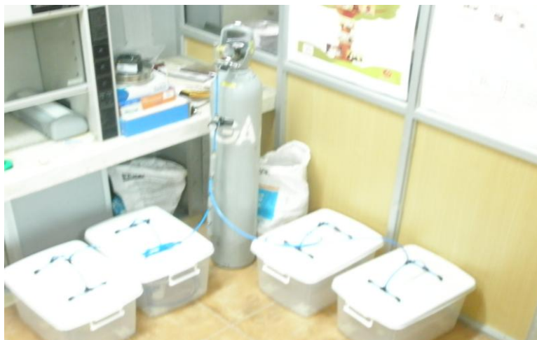
Fig. 2.21 Diseño inicial de cámaras de carbonatación
