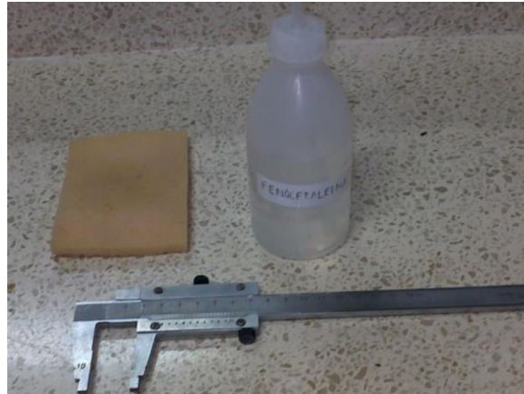
Fig. 2.25 Elementos utilizados para instrumentación de carbonatación
