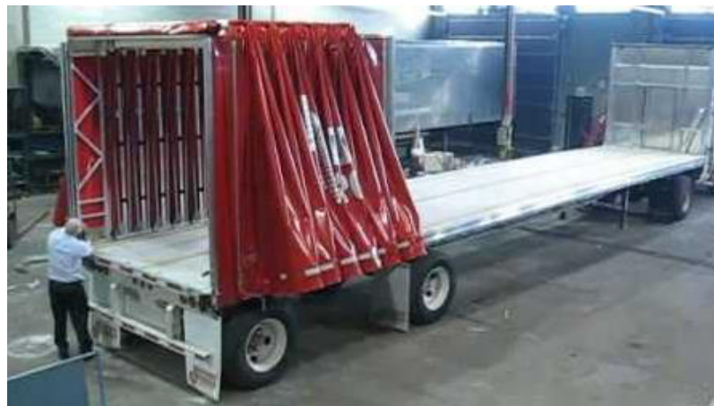
Figura 1.5. PLATAFORMA CON ENTOLDADO
