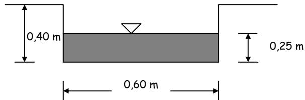
**Figura 12.** Esquema de la sección del canal.
