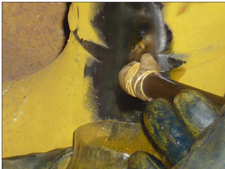
Figura 2.9 MOVIMIENTOS CIRCULARES PARA EL PULIDO, CON UNA PRESIÓN RELATIVAMENTE BAJA PARA NO QUEMAR EL PAÑO
