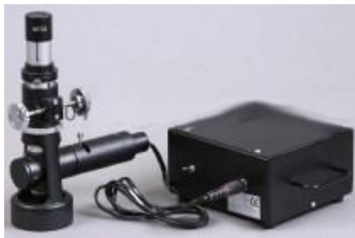
Figura 2.11 MICROSCOPIO METALGRÁFICO PORTÁTIL UTILIZADO EN EL PROYECTO
