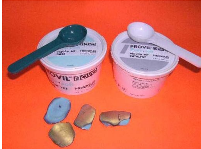
Figura 1.3 RÉPLICAS DE GOMA, SE MEZCLAN DOS COMPONENTES Y SE OBTIENE UNA PASTA.
