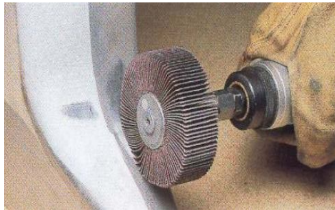
Figura 1.29 PULIDO MECÁNICO “IN SITU” CON ABRASIVOS Y FELPAS CON PASTA DIAMANTADA.
