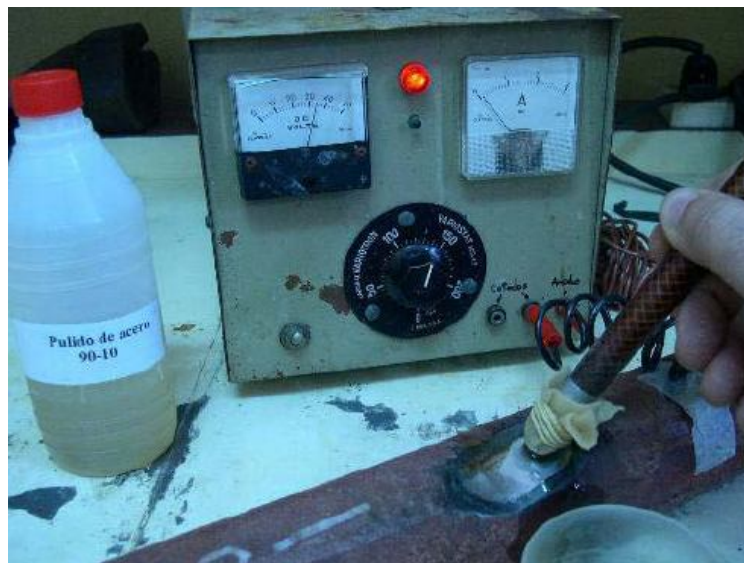
Figura 1.34 FUENTE DE CORRIENTE CONTINUA PARA PULIDO ELECTROQUÍMICO.
