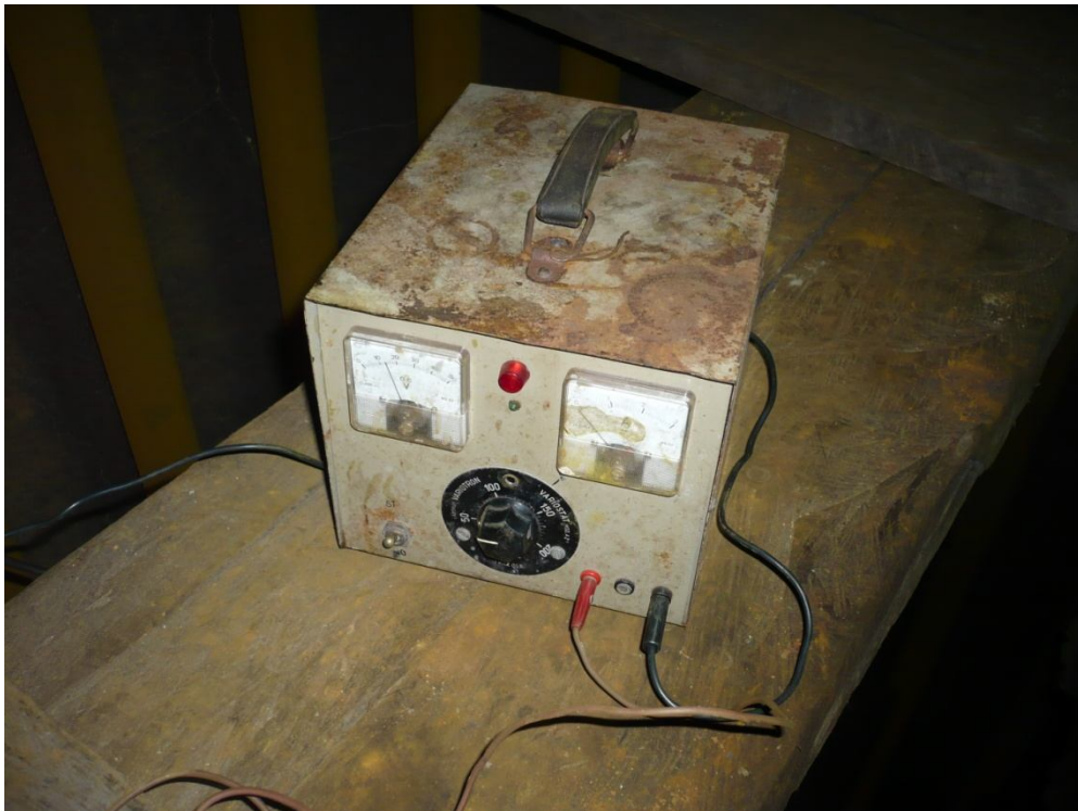
Figura 2.6 RECTIFICADOR DE CORRIENTE DC - AC
