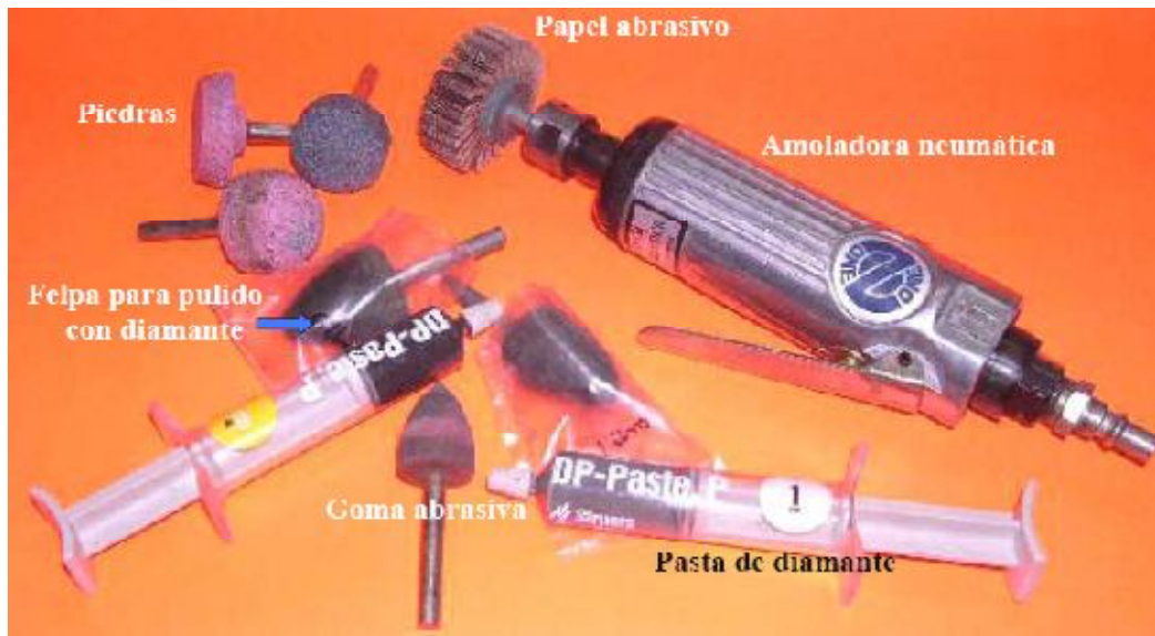
Figura 1.30 ELEMENTOS UTILIZADOS PARA PREPARAR SUPERFICIES METÁLICAS CON PULIDO MECÁNICO
