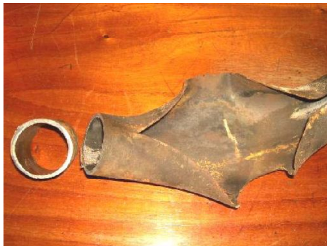
Figura 1.21 TUBO DE SOBRECALENTADOR FISURADO, CON CORROSIÓN-EROSIÓN EN LA PARED EXTERIOR.
