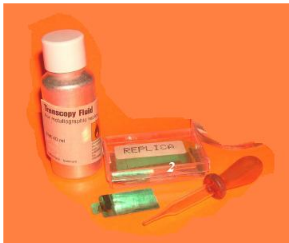
Figura 1.5 EQUIPO PARA REPLICAS FABRICADO POR STRUERS, INCLUYE EL SOLVENTE Y EL KIT CON 50 REPLICAS
