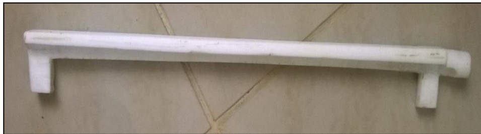
FIGURA. 2.18. PIEZA DE TEFLÓN QUE SOSTIENE EL HILO.
