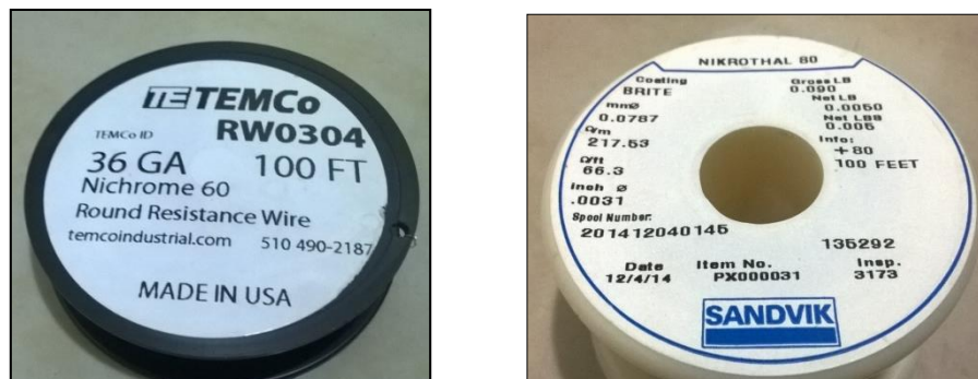
FIGURA. 2.2. HILOS RESISTIVOS DE NICROMO 60 Y NIKROTHAL 80 USADOS COMO FUENTE DE CALOR EN EL EQUIPO.
