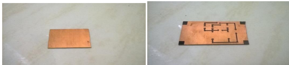
FIGURA. 2.8. IZQ. BAQUELITA LIBRE DE IMPUREZAS Y LIMPIA. DER. BAQUELITA CON LAS PISTAS DEL CIRCUITO DIBUJADAS.
