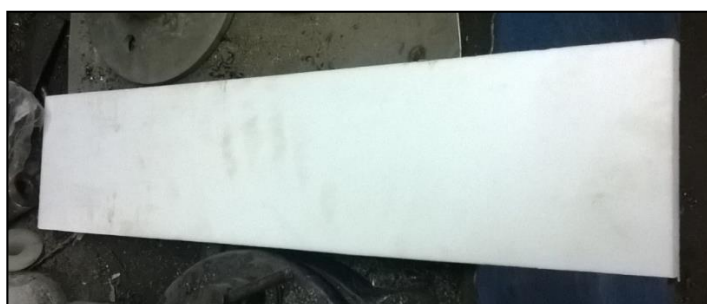
FIGURA. 2.15. PIEZA DE TEFLÓN UTILIZADA PARA HACER LA PIEZA QUE SOSTIENE EL HILO RESISTIVO.
