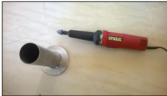
FIGURA. 2.16. CONTENEDOR METÁLICO ANTES DEL PROCESO DE LIJADO CON AMOLADORA.
