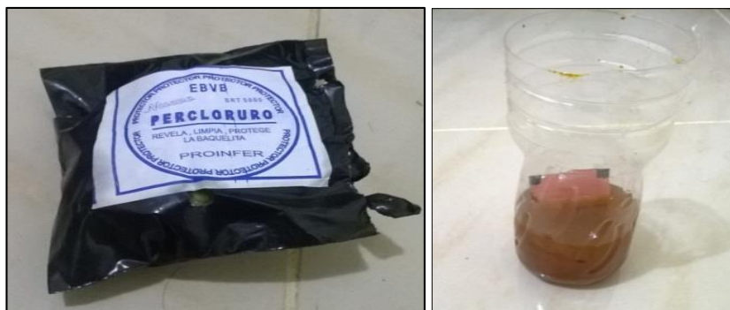
FIGURA. 2.9. PERCLORURO Y BAQUELITA DURANTE EL BAÑO PARA REMOVER EL COBRE RESTANTE DE LA BAQUELITA.
