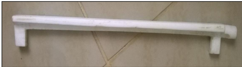
FIGURA. 2.18. PIEZA DE TEFLÓN QUE SOSTIENE EL HILO.
