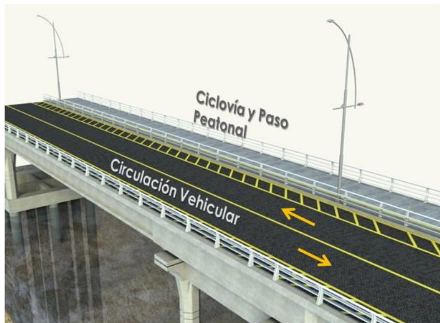
FIGURA 1.1 DISTRIBUCIÓN DE CARRILES DEL PUENTE (2)
