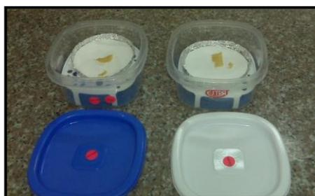
**Figura 6. Sistemas de desorción de isotermas empleados**
