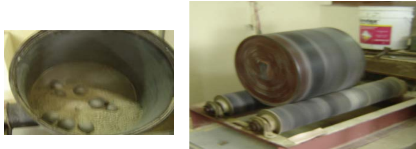
FIGURA 3.10. MOLIENDA EN EL MOLINO DE BOLAS
