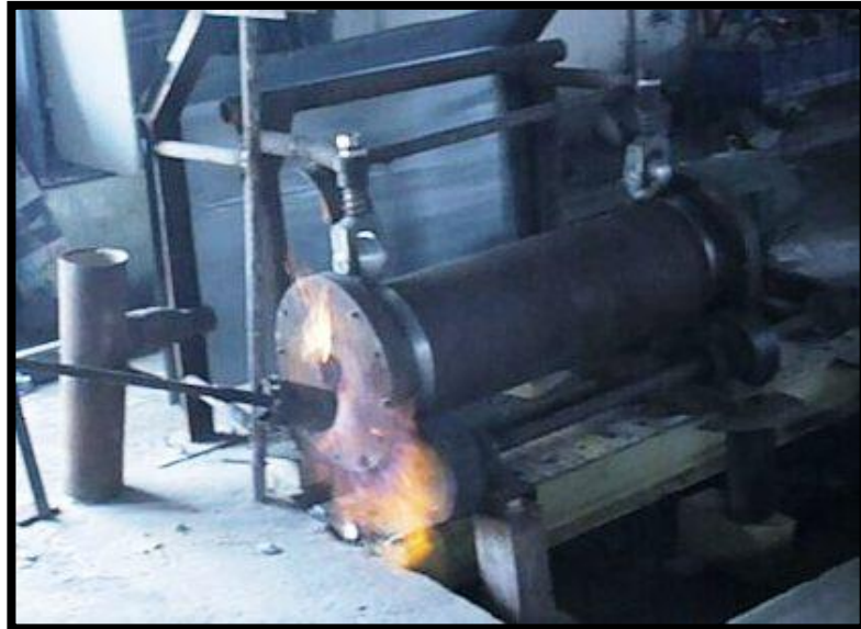
FIGURA 1.12 PRECALENTAMIENTO DEL MOLDE
