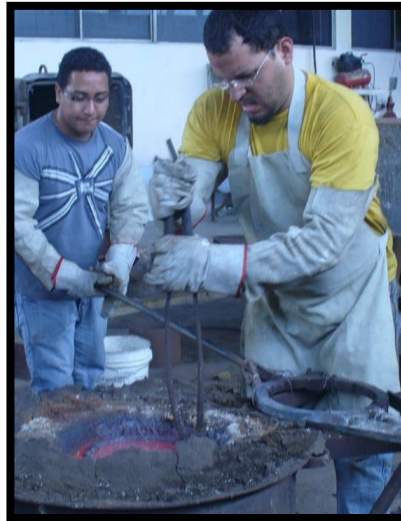
FIGURA 1.13 FABRICACIÓN DE LA ALEACIÓN EN HORNO
