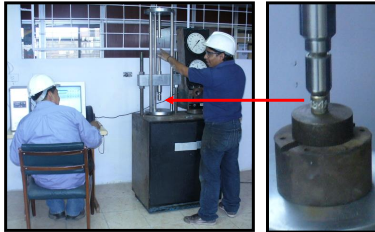
FIGURA 2.10 DUROMETRO BRINELL: DISEÑO DE INTRAMET
