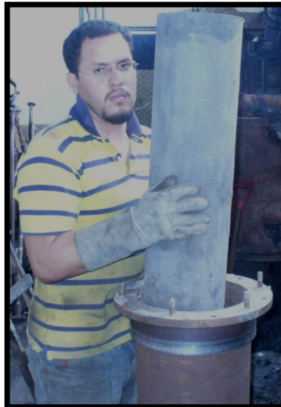
FIGURA 1.11 PREPARACIÓN DE MOLDE DE ARENA EN EL TUBO CENTRIFUGADOR
