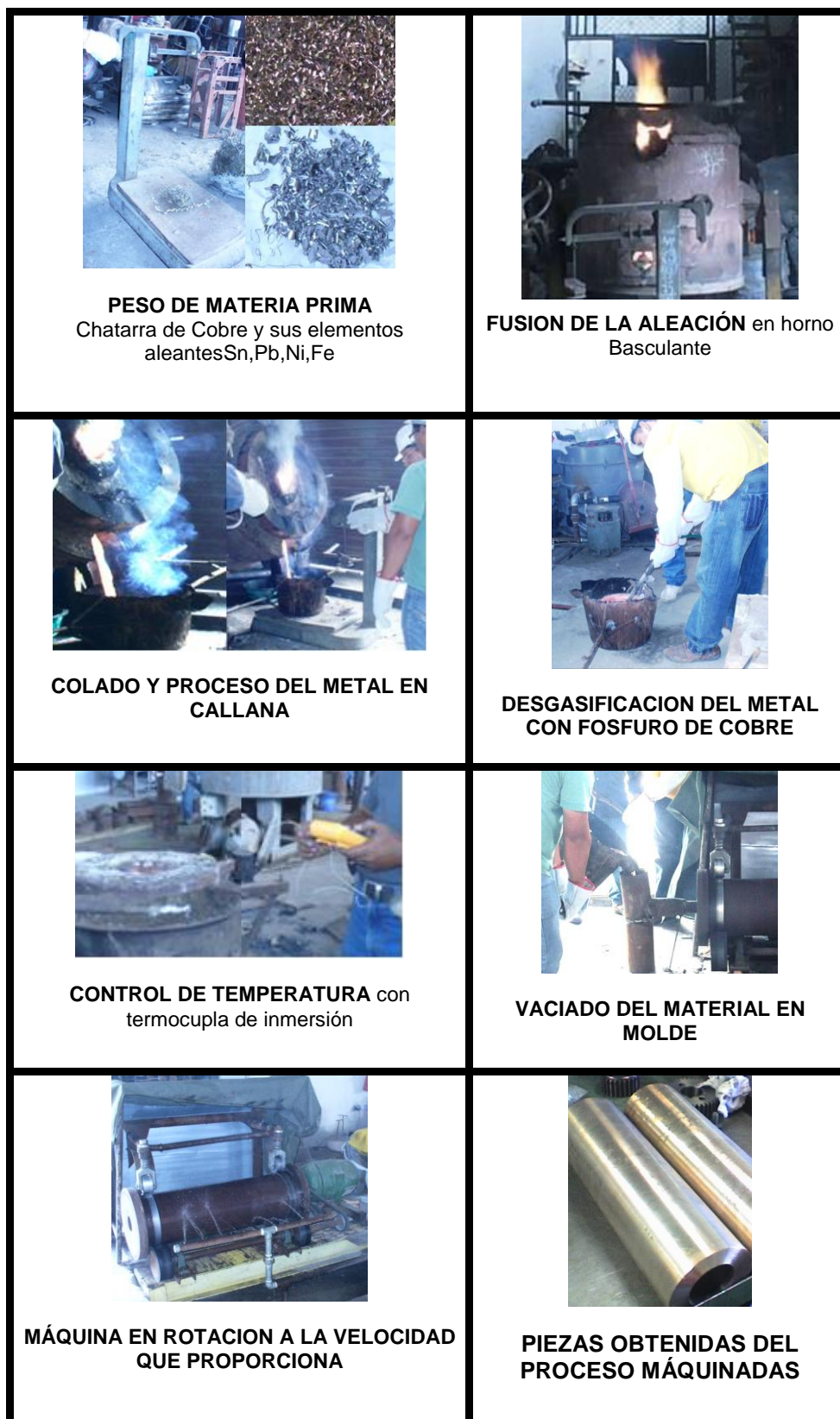
FIGURA 2.20 FOTOGRAFIAS DEL PROCESO DE CENTRIFUGACIÓN
