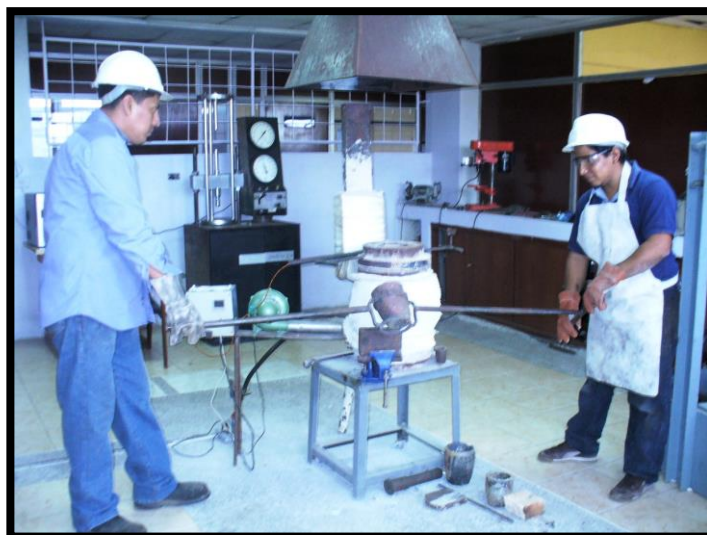
FIGURA 2.12 HORNO DE LABORATORIO ULTRARAPIDO, HASTA 1500°C EN 15 MIN. CON SISTEMA DE CONTROL AUTOMÁTICO CON PRECISIÓN DE TEMPERATURA + - 10°C- DISEÑO INTRAMET
