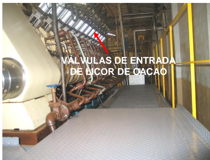
FIGURA 4.9. VISTA DE PRENSA Y SUS VALVULAS
