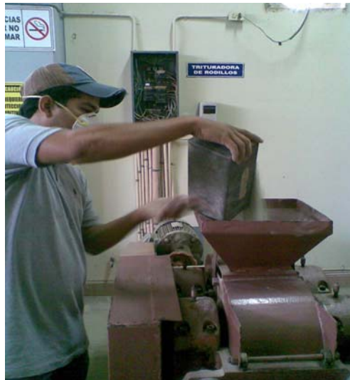
FIGURA 3.5 INGRESO DE ZEOLITA 2 A LA TRITURADORA DE RODILLO
