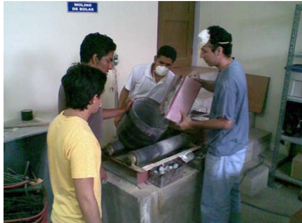
FIGURA 3.9 ALIMENTACIÓN DE ZEOLITA 2 A LA TRITURADORA DE BOLAS
