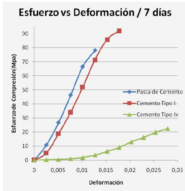
FIGURA 4.3. GRÁFICO ESFUERZO VS DEFORMACIÓN A LOS 7 DÍAS DE CURADO EN AGUA
