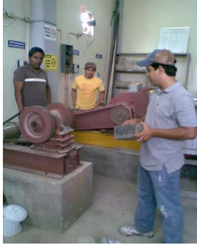
FIGURA 3.4 ALIMENTACIÓN DE ZEOLITA 2 A LA TRITURADORA DE MANDÍBULA
