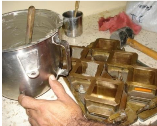
FIGURA 3.16 VACIADO EN MOLDE
