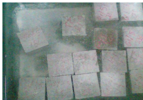
FIGURA 3.23. PROBETAS SUMERGIDAS EN AGUA
