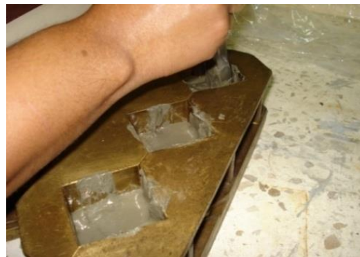
FIGURA 3.17 LLENADO DE MOLDES
