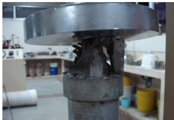
FIGURA 3.28. RUPTURA DE MUESTRA
