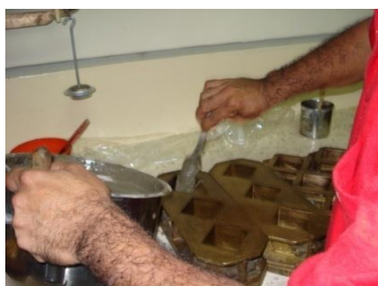
FIGURA 3.15. MEZCLA EN MOLDES
