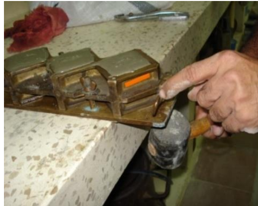
FIGURA 3.19 COMPACTADO DE MOLDES
