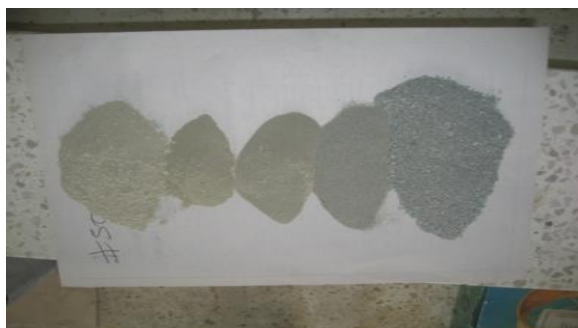
FIGURA 3.5. TAMAÑO DE PARTÍCULAS DE ZEOLITA
