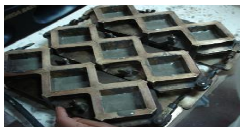
FIGURA 3.4 LLENADO DE PRIMERA CAPA DE MEZCLA
