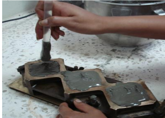
FIGURA 3.5 LLENADO DE LA SEGUNDA CAPA DE MEZCLA
