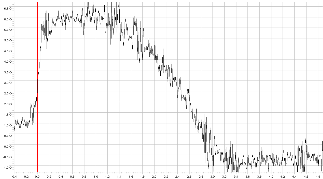
Figura 6.9 Medición de la Aceleración vs. Tiempo del Arreux con el motor G33 durante el tiempo de combustión.
