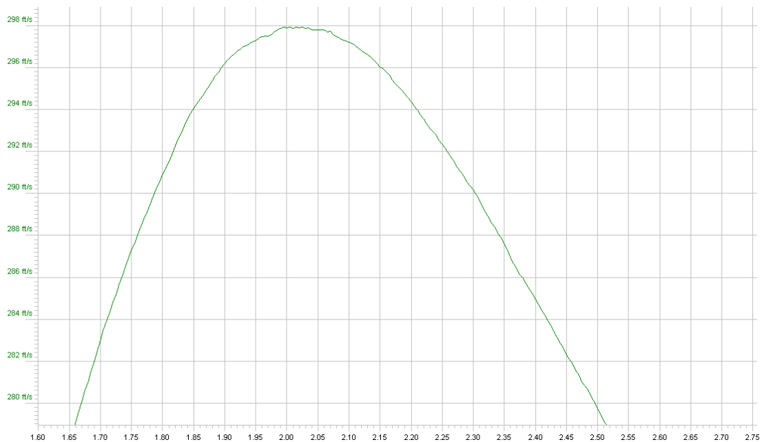
Figura 6.3 Medición de la Velocidad vs. Tiempo del Arreaux con el motor F40 durante el ascenso.
