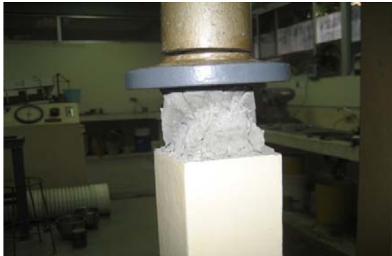
FIGURA [3.14] PROBETA DEFORMADA EN ENSAYO DE RUPTURA
