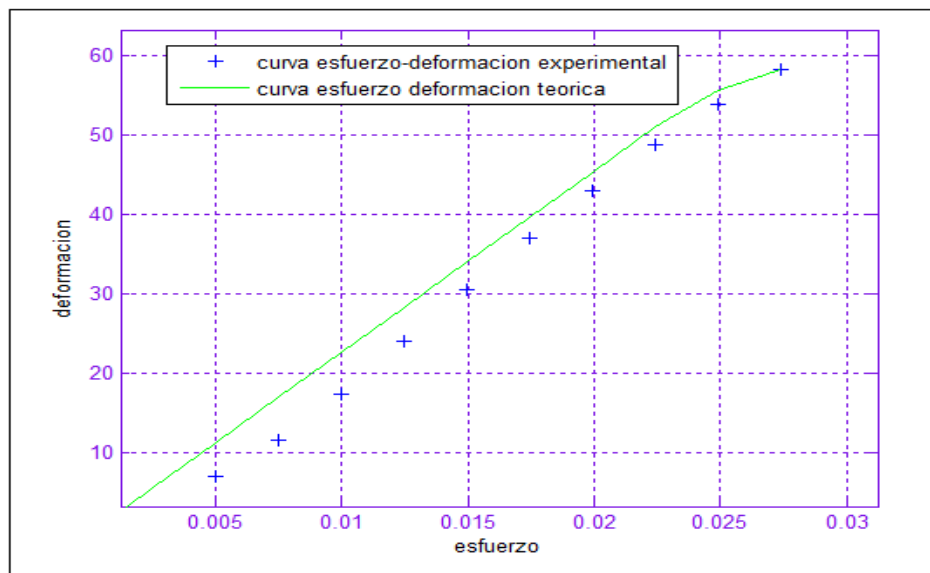
FIGURA [4.6] CURVAS ESFUERZO DEFORMACIÓN PROMEDIO CON 20% DE ZEOLITA A 14 DÍAS DE CURADO
