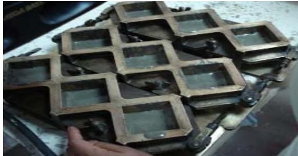
FIGURA. [3.10] LLENADO DE PRIMERA CAPA DE MEZCLA
