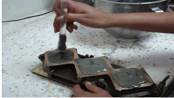
FIGURA. [3.12] LLENADO DE SEGUNDA CAPA DE MEZCLA
