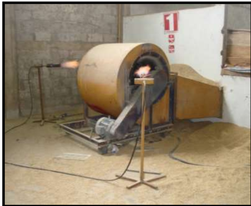
FIGURA 1.4. VENTILADOR Y QUEMADOR DE GLP
