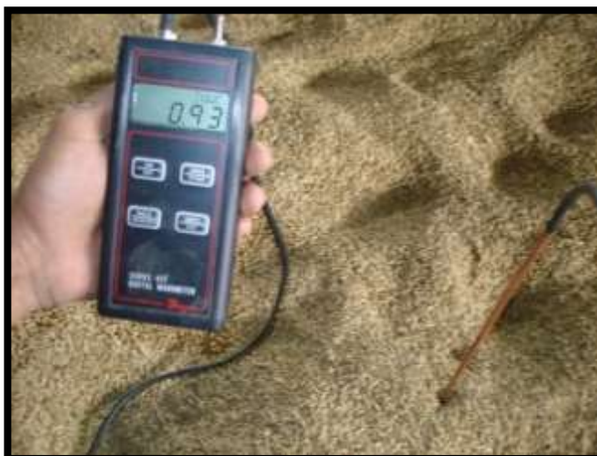
FIGURA 1.5. TUBO DE PITOT Y MANÓMETRO EN GRANOS
