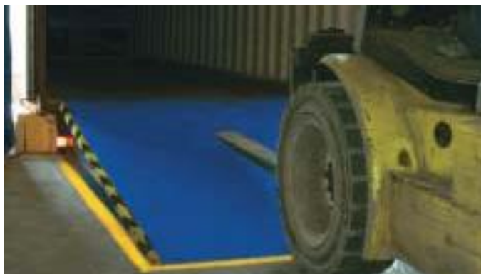
FIGURA 5.5. FOTO DE RAMPA DE ALTURA VARIABLE
