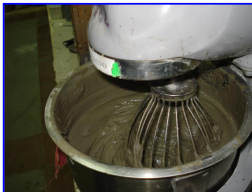
FIGURA [3.22] CEMENTO + ZEOLITA + AGUA EN LA MEZCLADORA
