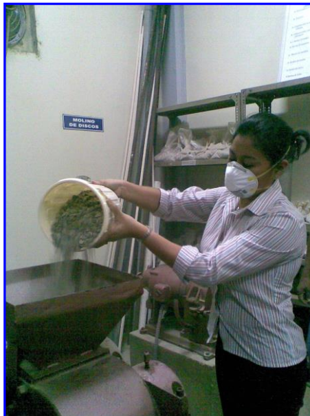
FIGURA [3.6] ADICIONANDO ZEOLITA EN MOLINO DE RODILLOS
