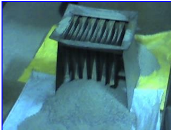
FIGURA [3.12] SEGUNDO CUARTEO DEL MATERIAL
