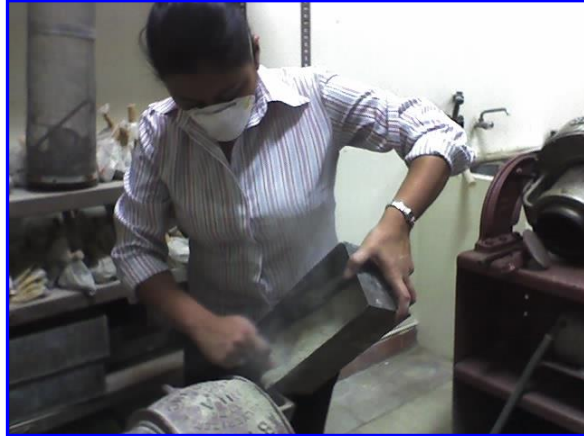
FIGURA [3.11] AGREGANDO MATERIAL AL MOLINO DE DISCOS
