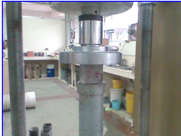
FIGURA [3.30] PROBETA EN EQUIPO DE ENSAYO UNIVERSAL
