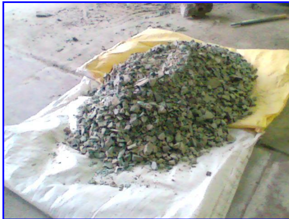
FIGURA [3.3] GRANULOMETRÍA DE ZEOLITA AL SALIR DE MOLINO DE MANDÍBULAS
