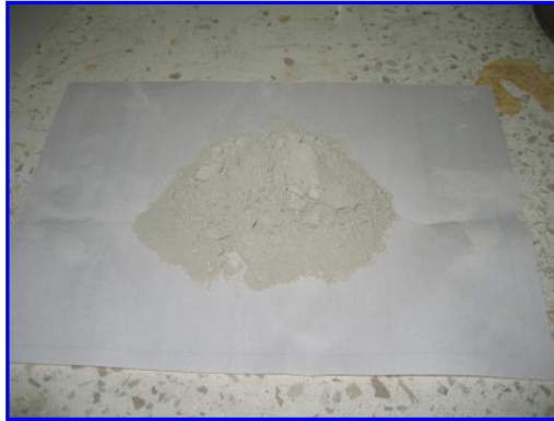
FIGURA [3.17] ZEOLITA CON GRANULOMETRÍA FINAL 45 \mu\text{m}
