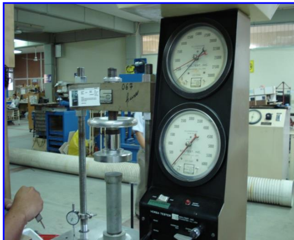
FIGURA [3.29] CALIBRANDO EQUIPO DE ENSAYOS
