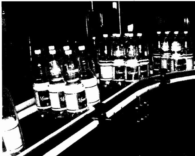
FIGURA 2.4 TRANSPORTACIÓN DE BOTELLAS MEDIANTE BANDA ARTICULADA
