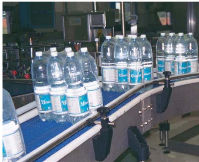
FIGURA 2.4 TRANSPORTACIÓN DE BOTELLAS MEDIANTE BANDA ARTICULADA
