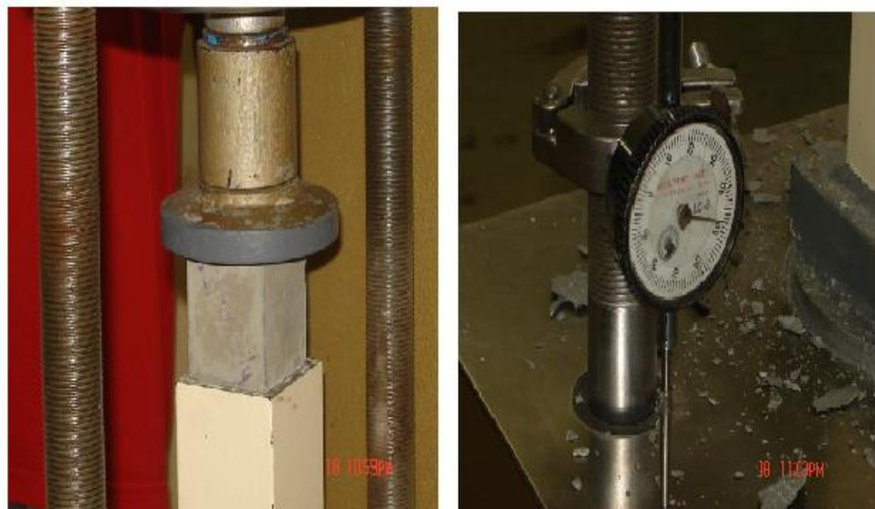
FIG 3.11 ENSAYO DE COMPRESIÓN
