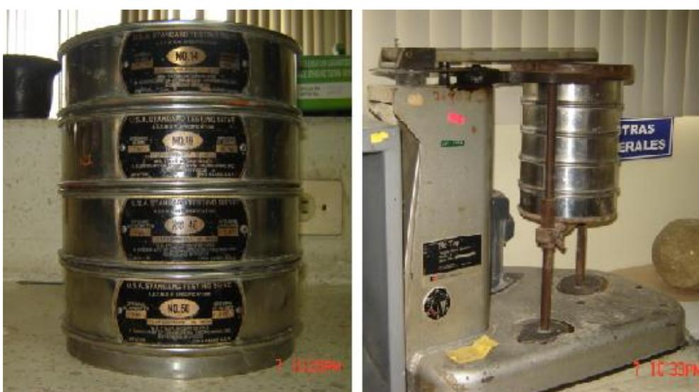
FIG 3.3 TAMICES Y TAMIZADOR ELECTRICO
