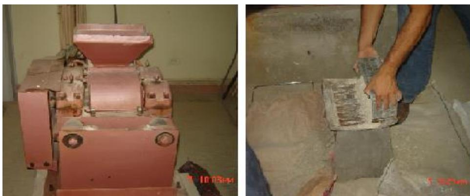
FIG 3.2 TRITURADORA DE RODILLOS Y SEPARADOR
