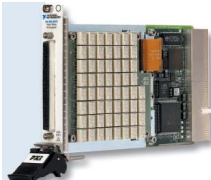
Figura 1.5.- Tarjeta de 98 canales dobles multiplexados PXI-2575
