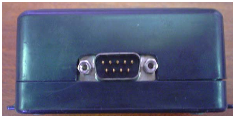
Figura 3.16.- Vista del Convertidor de Interfase RS-485 a RS-232
