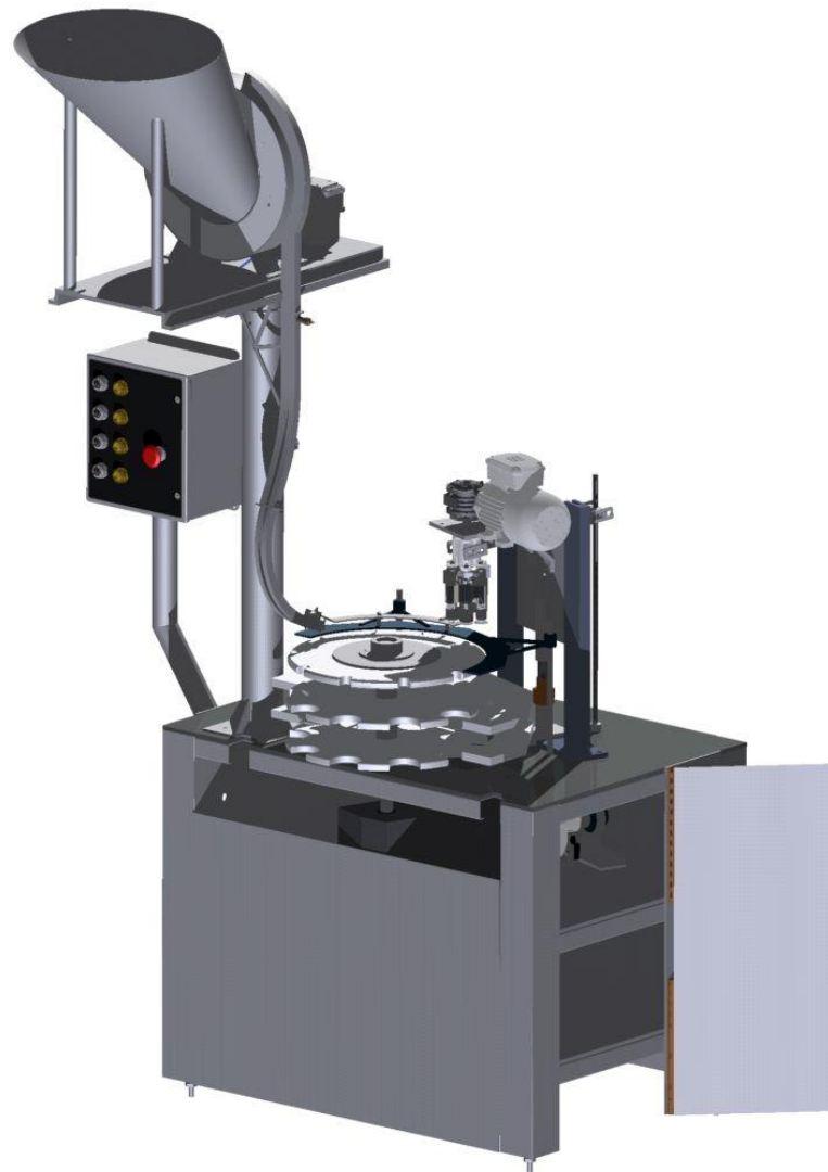
FIGURA 3.51. SISTEMA DE ROSCADO DE TAPAS INVIOLABLES.
