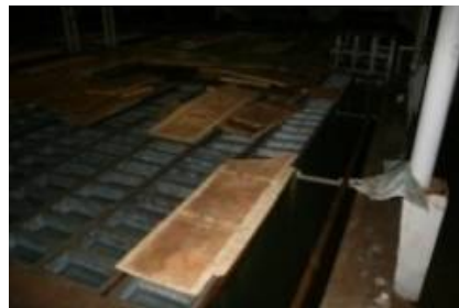
FIGURA 3.6 PROCESO DE CONGELAMIENTO DE HIELO DENTRO DE PISCINA DE SALMUERA
