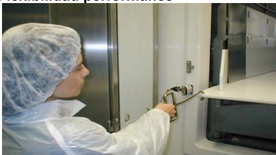
La placa se puede cambiar fácilmente. Con una placa de reserva el cambio de producto es hecho en unos pocos minutos
