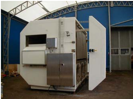
Puerta lateral completamente abierta para el acceso interior. Piso inclinado hacia la abertura
