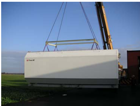
Congelador 4000 kg por hora se prepara y ensambla en la fábrica
