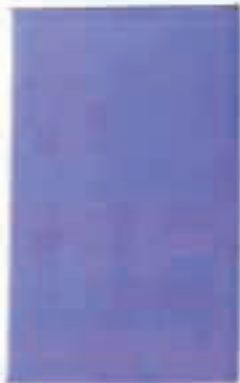
ACABADO FRESADO 2B Acabado de laminado en frío para propósitos generales (7 ga. o más liviano)
