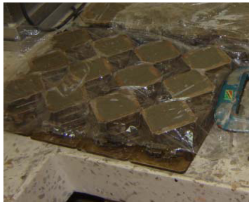
FIGURA 3.2. ALMACENAMIENTO DE MOLDES CON LA MEZCLA
