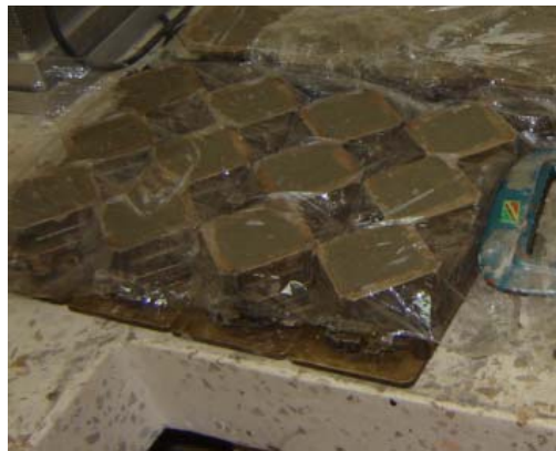
FIGURA 3.2. ALMACENAMIENTO DE MOLDES CON LA MEZCLA
