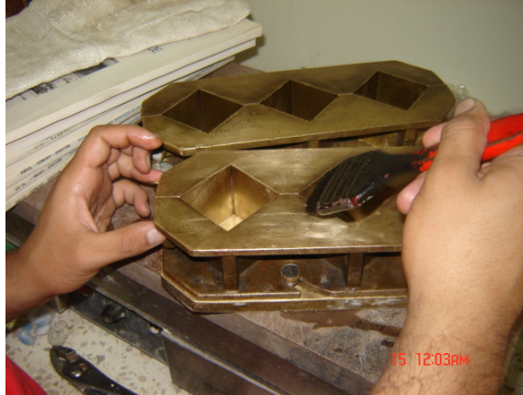
FIGURA 3.1. PREPARACION DE MOLDES
